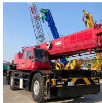
Rough Terrain Crane 60 Ton Tadano GR 600N-1
