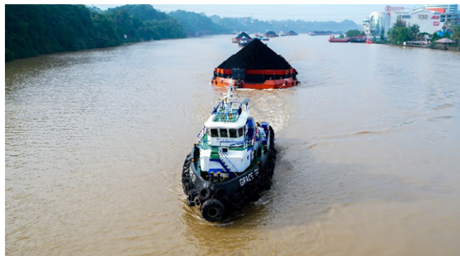
Proses penarikan tongkang laut menuju FTU
